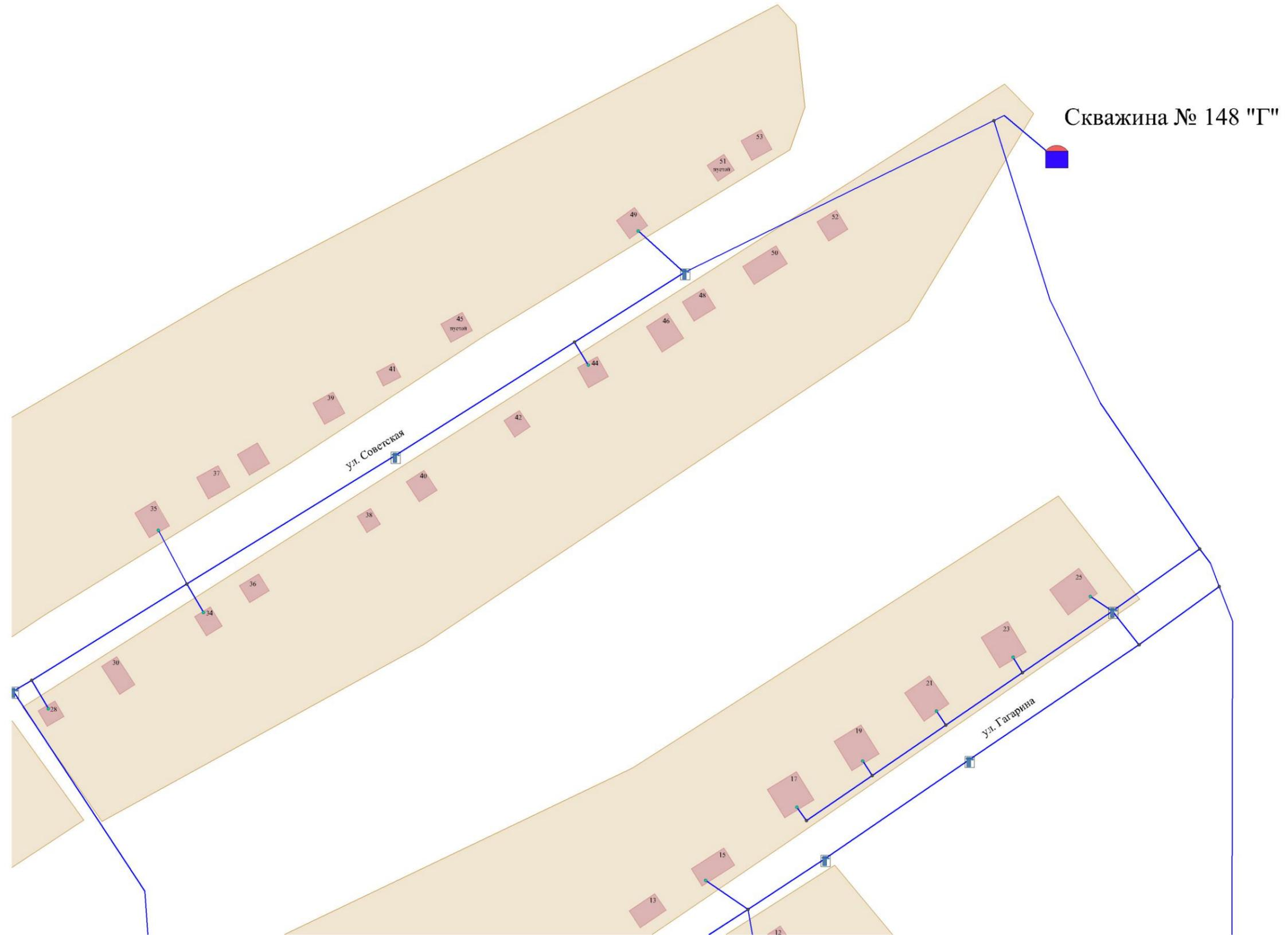
Рисунок 5.2 – Схема существующего размещения объектов централизованной системы водоснабжения
