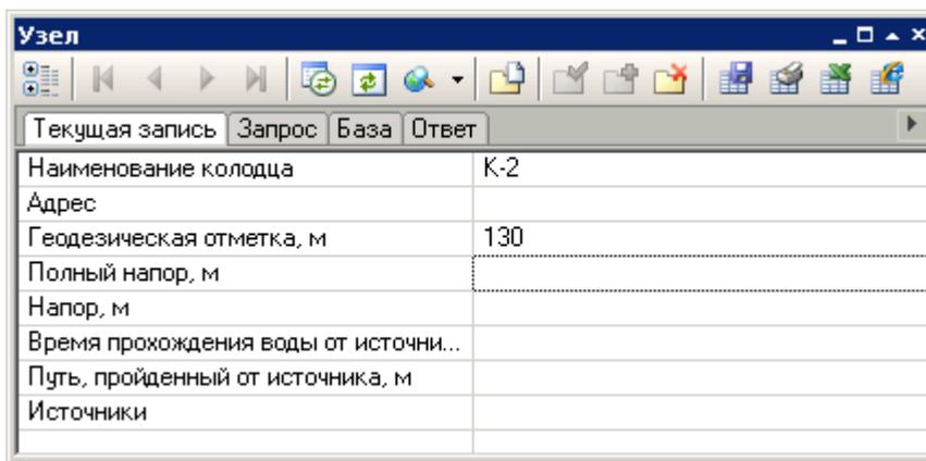
Рисунок 10.7 – Окно ввода параметров для узла водопроводной сети
