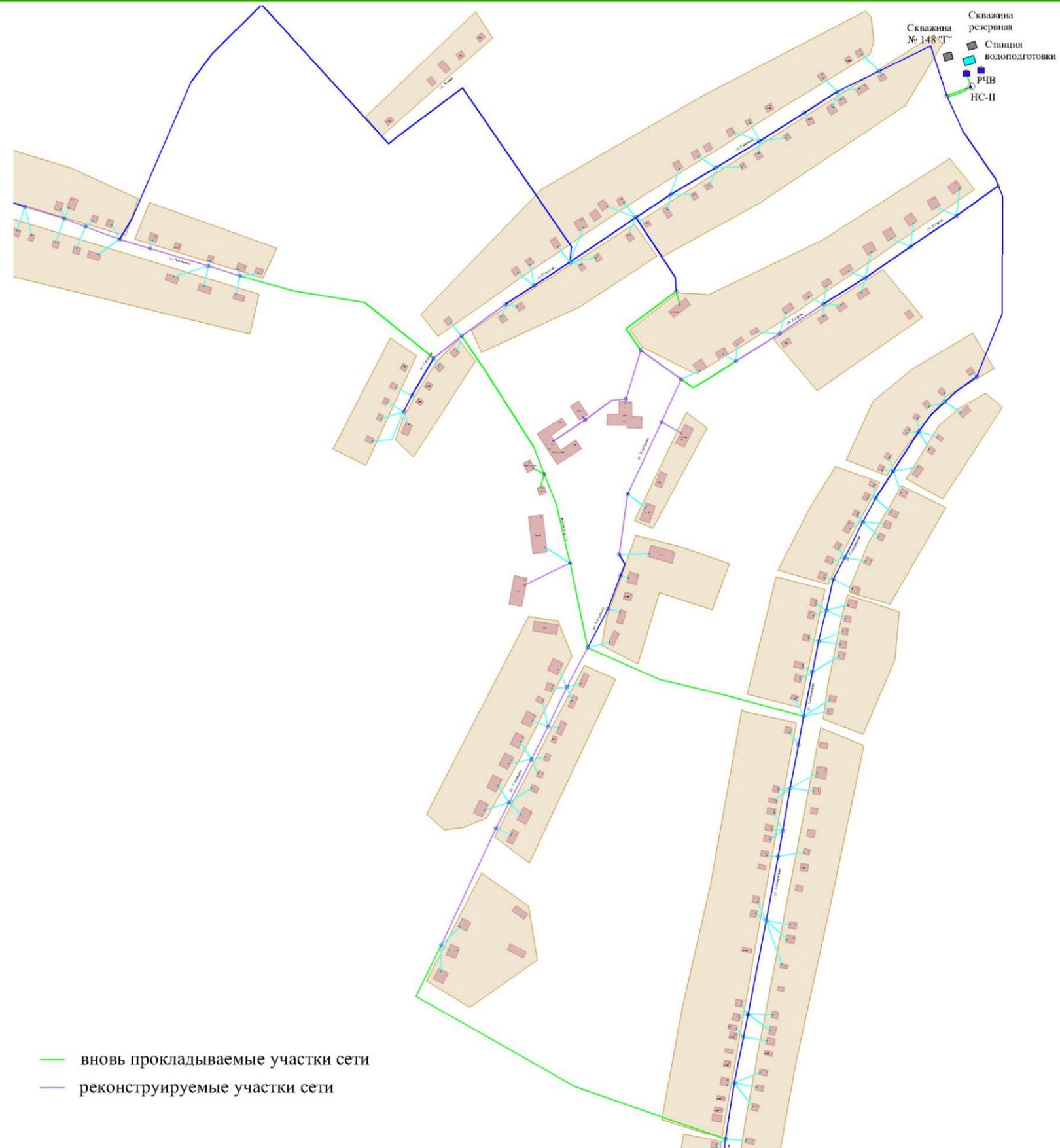
Рисунок 5.3 – Схема планируемого размещения объектов централизованной системы водоснабжения
