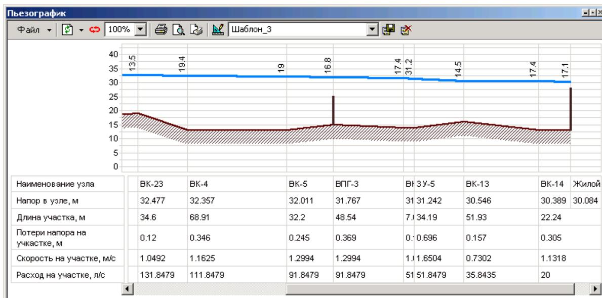
Рисунок 10.8 – Пример пьезометрического графика
