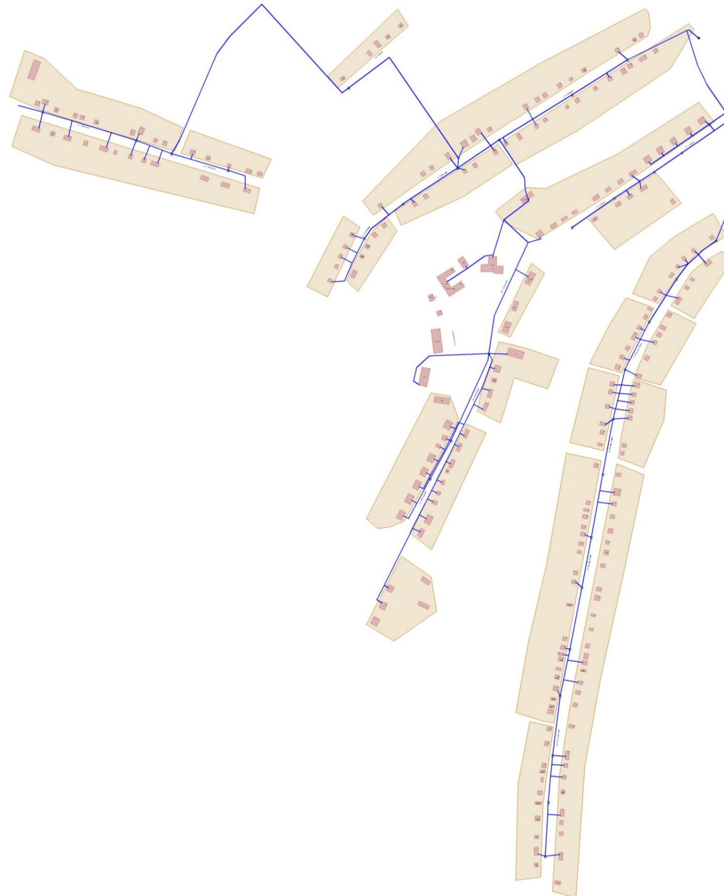
Рисунок 2.1 – Зона централизованного водоснабжения с. Новомихайловка
