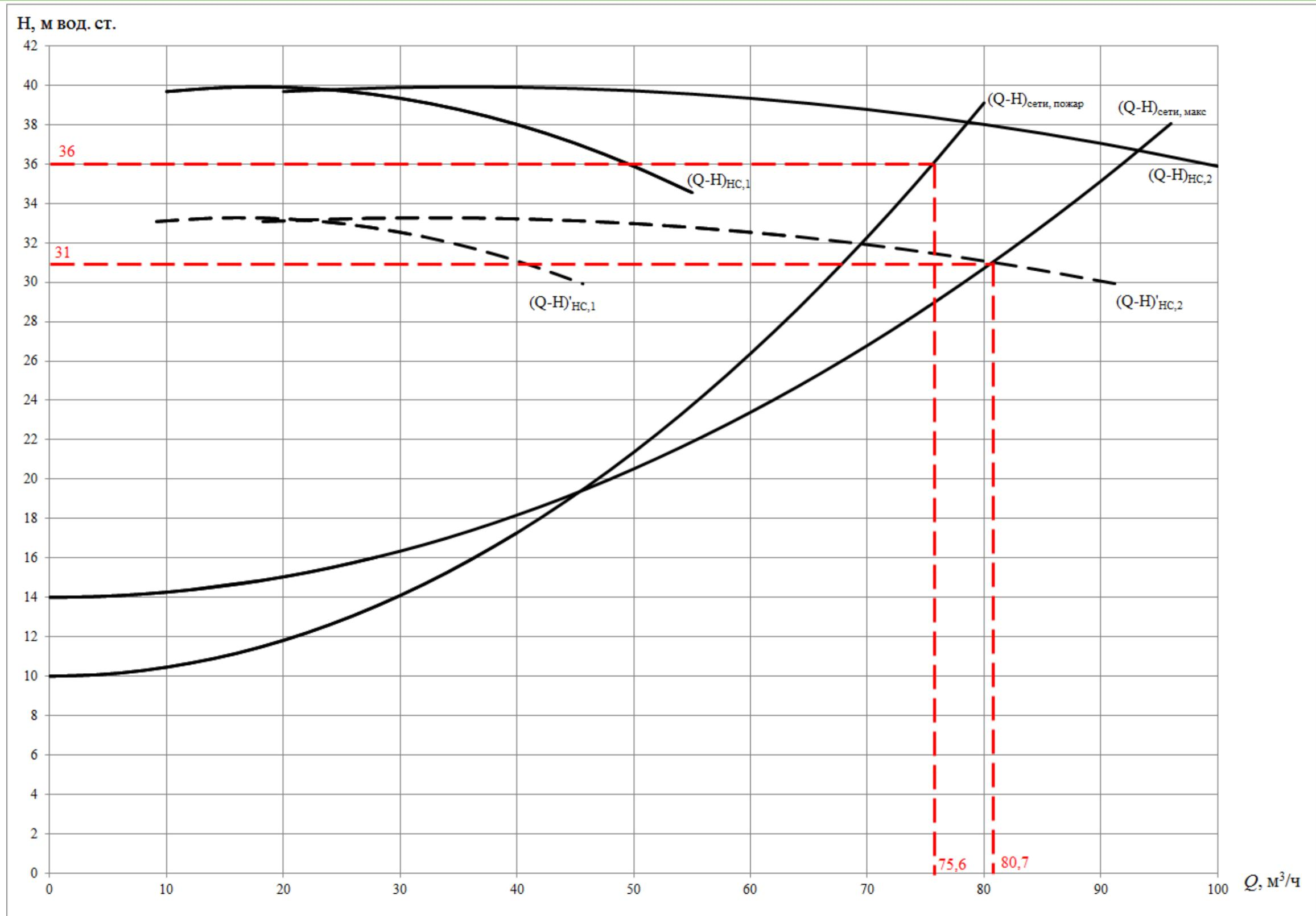
Рисунок 5.1 – Совмещенные расходно-напорные характеристики насосов и водопроводной сети при расчетных режимах работы сети
